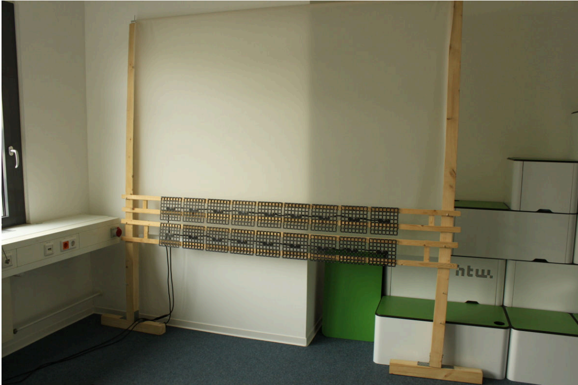
Abbildung 3.2.: Testaufbau mit Rückprojektionsfolie und LED-Modulen
