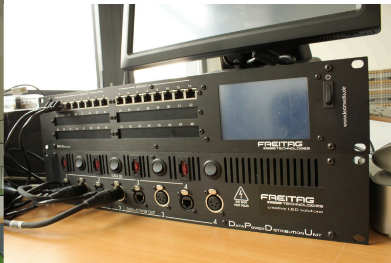
(b) LED Steuerungsmodul des Testaufbaus (Kontrollmonitor oben (angeschnitten), DVI-Controller darunter, LED-Controller ganz unten)
