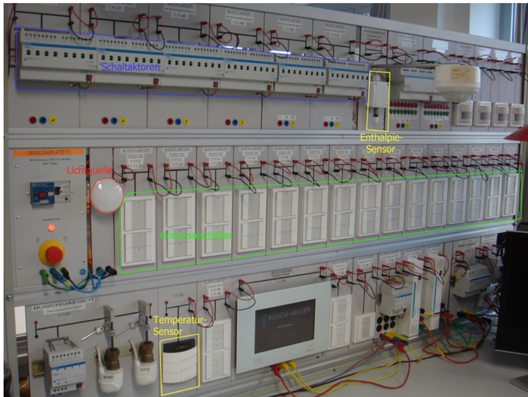
Abbildung A.11: KNX-Gebäudeautomationsinstallation
