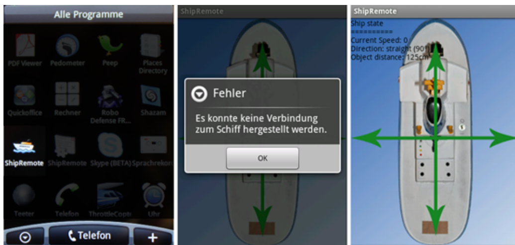
Abbildung 6.3: Start der Applikation ShipRemote . Links: Eintrag im Programmennü, Mitte: Verbindung zum Schiff fehlgeschlagen; Rechts: Hauptbildschirm der Anwendung
