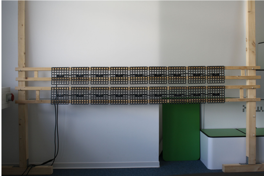
Abbildung 6.1: Aufbau des Testlabors mit Projektionsleinwand und LED-Kacheln
