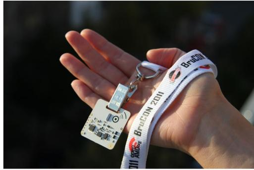
Abbildung 4.5: Aktiver RFID Transponder
