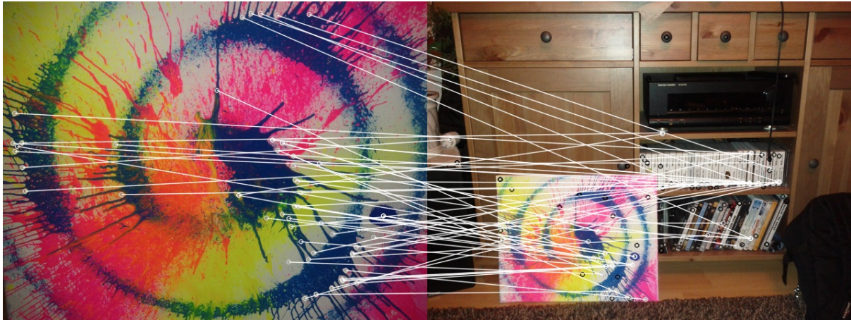
Abbildung 4: Matches der Featurepunkte (links Originalbild, rechts Vergleichsbild)
